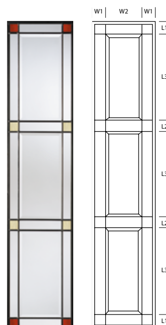
Vaste maat: W1 (43 mm), L1 (43 mm) en L2 (35 mm)
